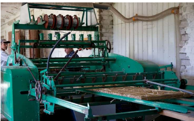
Saviukumaja valmistaa ruokolevyä samanlaisella Berger koneella kuin Suomessa käytettiin 1940 luvulla [3]
