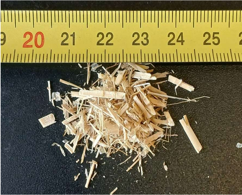
Kuva 2.2 Jäärviuokolevyjen valmistuksessa käytettyä jäärviuokosilppua.
