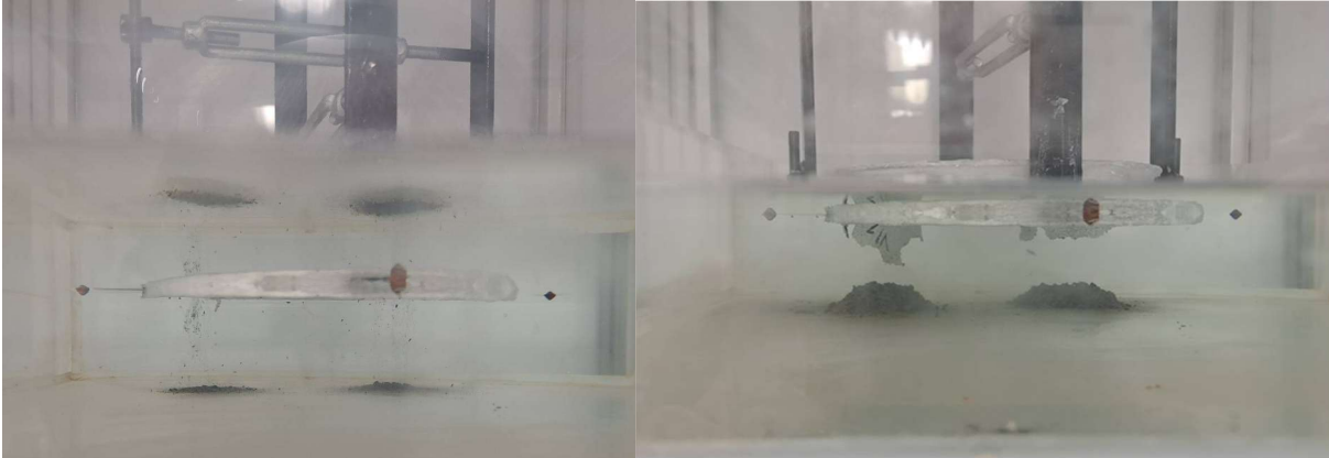
Kuva 3.6 Koekappale 1 heti vesikosketukseen saattamisen jälkeen ja noin tuntia myöhemmin.
