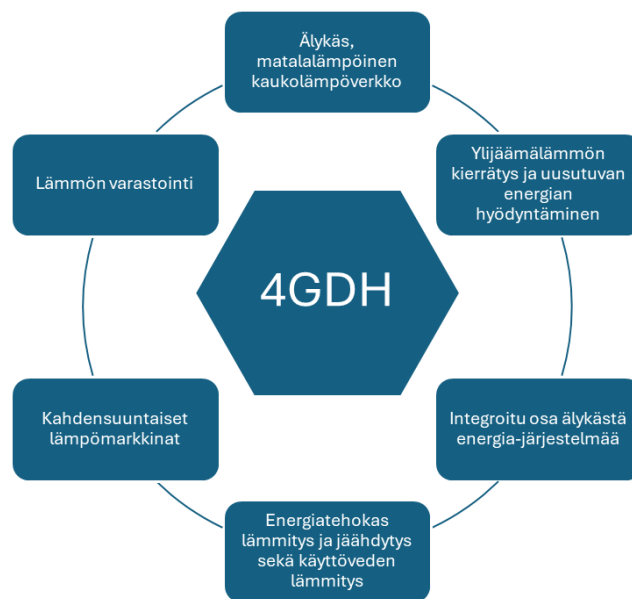
Kuva 2 Neljännen sukupolven kaukolämpöratkaisun (4GDH) ominaisuuksia (Kari 2018; Lund et al. 2014)
