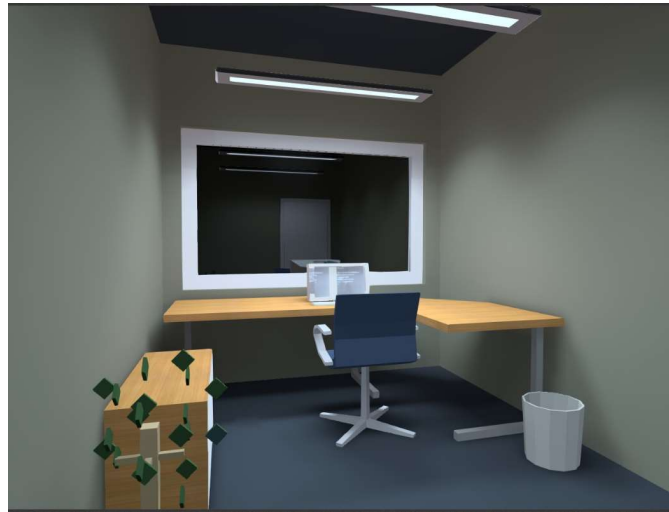
muutetaan hyvin tummiksi pinnoiksi (heijastussuhde 20 %). Valaistuksen sähköteho tarve nousee + 22 %.
