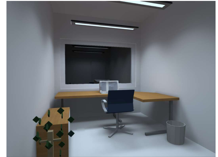
muutetaan hyvin vaaleiksi pinnoiksi (heijastussuhde 80 %) Valaistuksen sähköteho tarve laskee - 26 %
