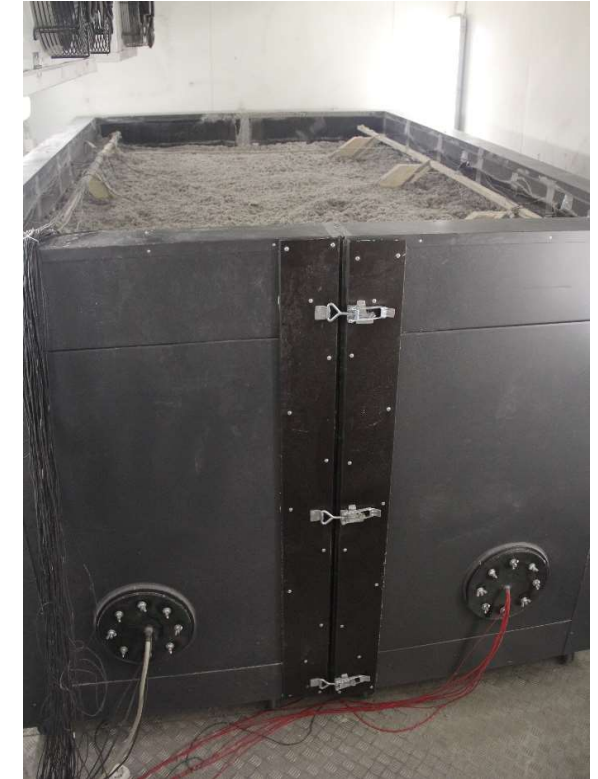
600 mm kerros puukuitupuhallusvillaa puhallettuna tutkimusaukkoon rakenteessa, jossa on kattoristikot
