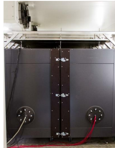
Yläpohjarakenteiden rakennusfysikaalinen tutkimuslaitteisto.
