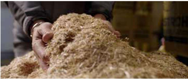
ISO-Strohn valmistamaa puhalluseristettä oljesta [2]
