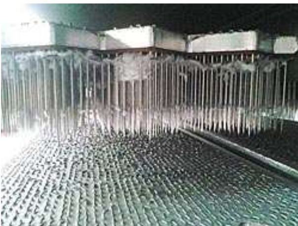
Isolana karstaa ja neulaa eristelevyä villasta entisen tekstiilitehtaan koneista muokatulla tuotantolinjalla [1]
