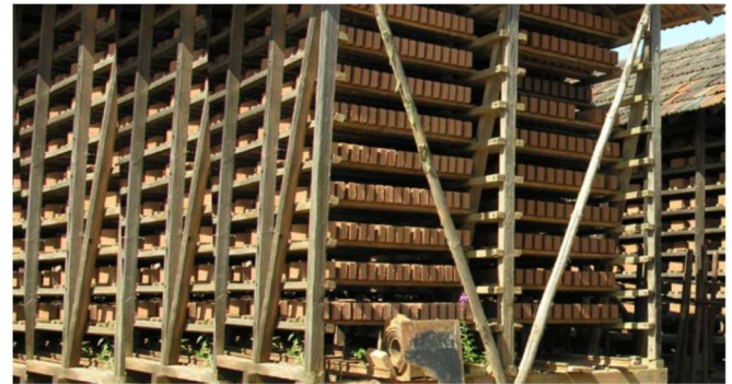
Gumbelin tehtaalla tiilien kuivausta ulkoilmassa [4]
