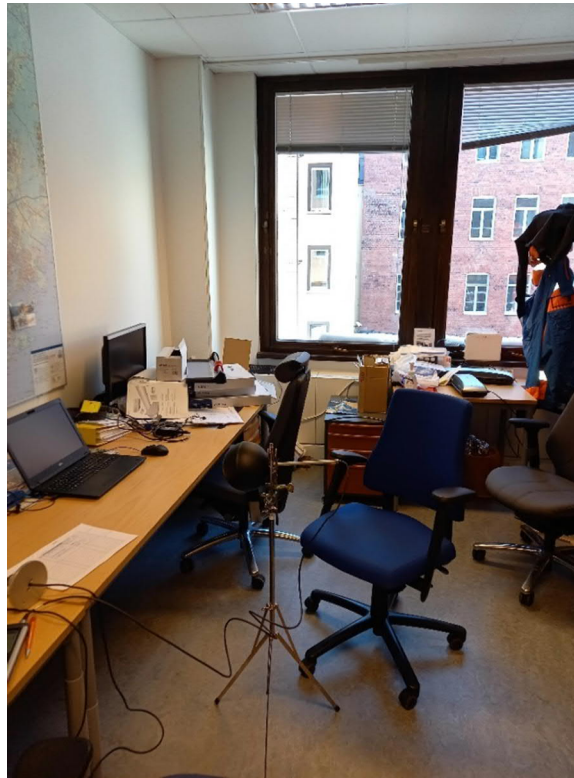
Kuva 2. Ilmavirran nopeuden ja lämpötilan mittauslaite (vas.) ja säteilylämpötilan mittauslaite (musta pallo, oik.).
