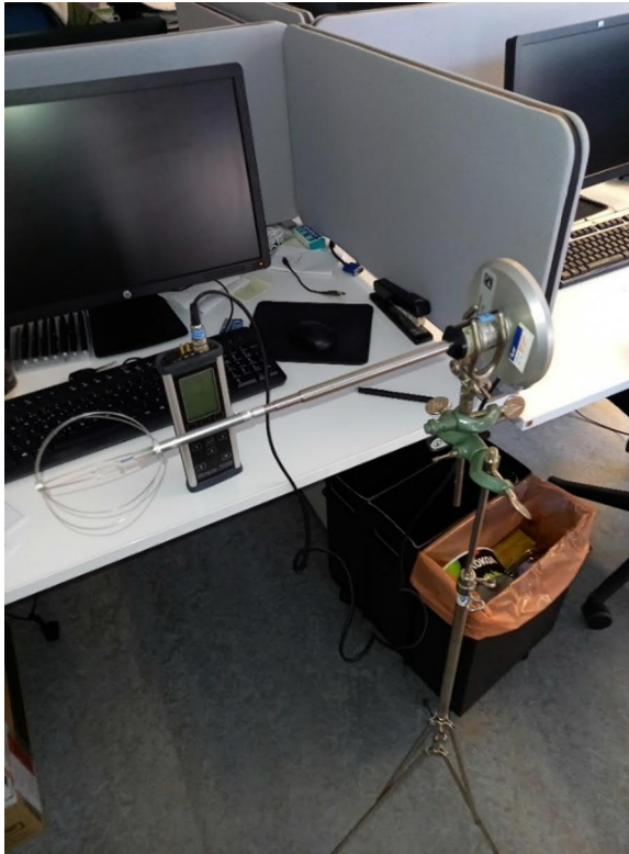
Kuva 2. Ilmavirran nopeuden ja lämpötilan mittauslaite (vas.) ja säteilylämpötilan mittauslaite (musta pallo, oik.).
