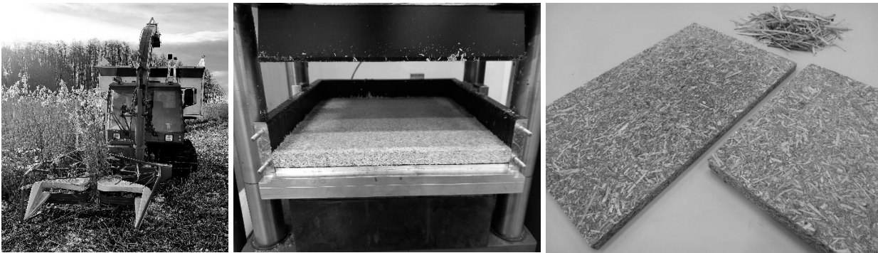
Kuva 2. Järviruo' on matka rannalta rakennuslevyksi.
