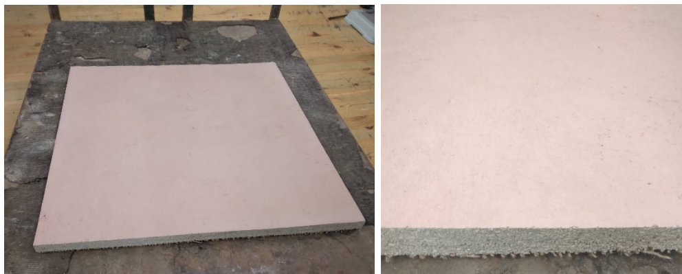
Kuvat 9 ja 10 , Biosivuhankkeessa kehitetty palonsuojalevy savesta hampun päistäreestä ja juuttiverkosta. Pintakäsittelynä Savimestareiden savimaali
