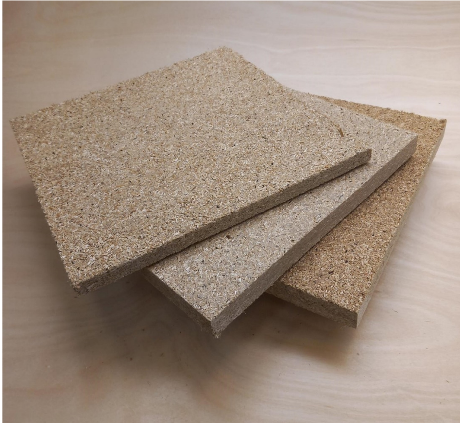
Kuva 15 Stalk-hankkeessa valmistettua levyä järviruo'osta ja tärkkelyksestä
