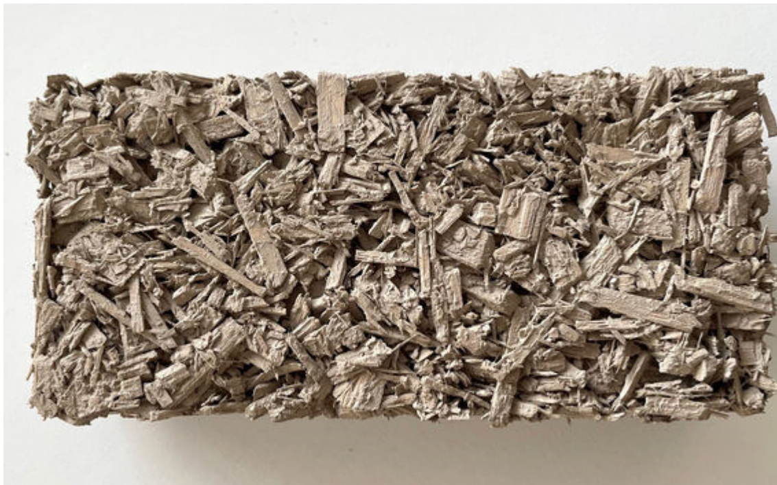
Kuva 13 Kevytsavi 1.1 -hankkeessa kehitetty kevytsaviitiili [41]
