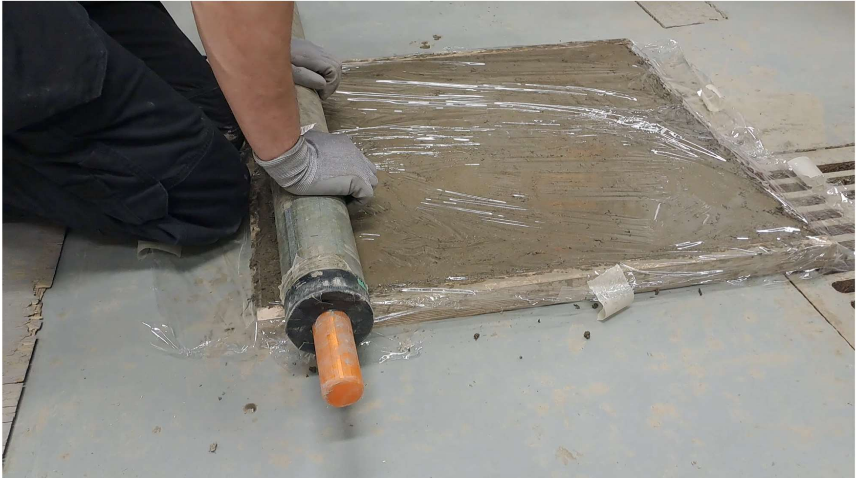
Savilevy valmistettiin valssaamalla useasta kerroksesta savi-päistäremassaa (415). Juuttiverkkoa on alapinnassa ja 3 mm yläpinnasta. Täysimittainen levy painaa alle 50 kg.
