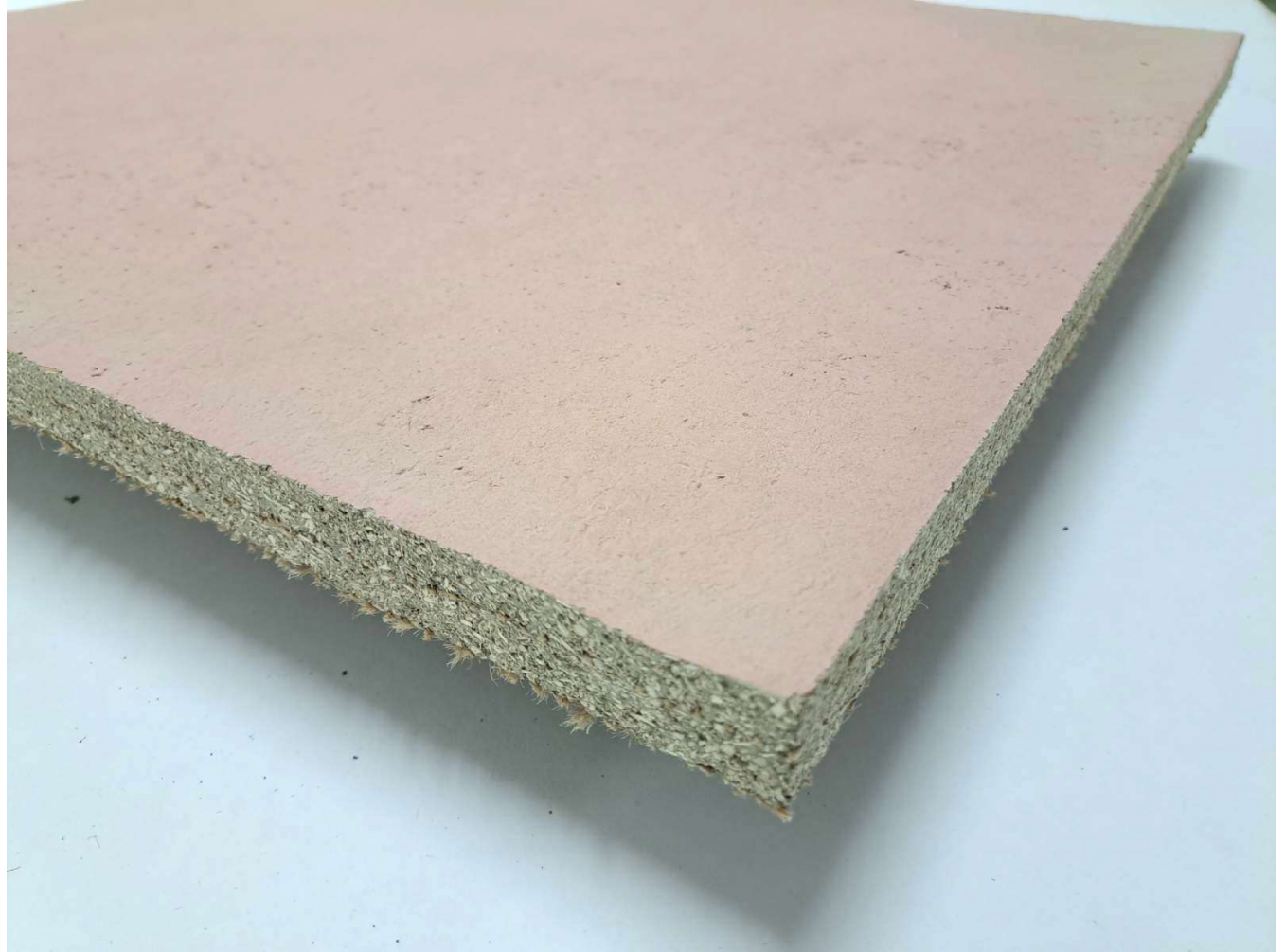
Savilevy kuivattiin ilmavirrassa ja levyn pinta maalattiin savesta ja tärkkelyksestä koostuvalla savimaalilla
